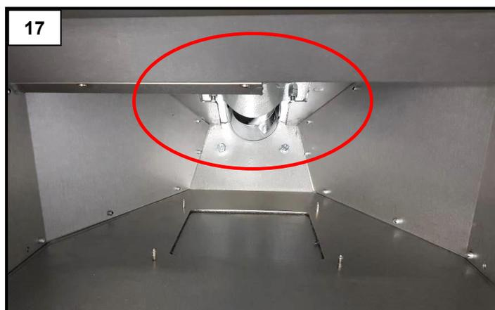
Pour un fonctionnement correct, il est nécessaire d'aspirer le dépôt de sciure sur le fond du réservoir (figure 17) au moins tous les 30 jours. **À chaque fin de saison, il faut vider complètement le réservoir à granulés.**
