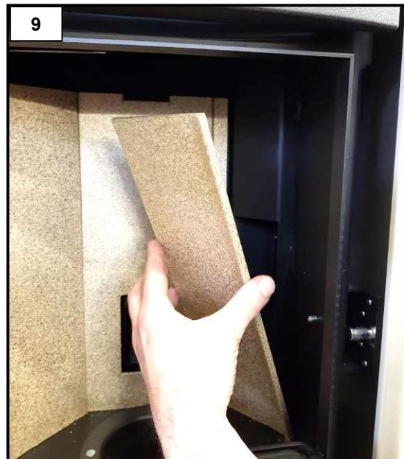
Retirer toutes les vermiculites à l'intérieur de la chambre de combustion (figures 8 et 9).
