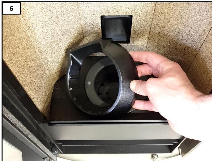
Enlever la bague de couverture du brasier et enlever les résidus de combustion (figure 5).
