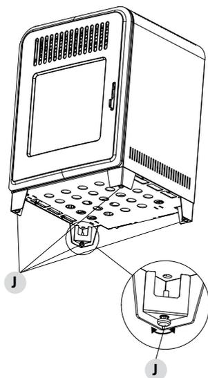
1. **TOURNER LES PIEDS DANS LE SENS DES AIGUILLES D'UNE MONTRE POUR BAISSER LE POÊLE.**
