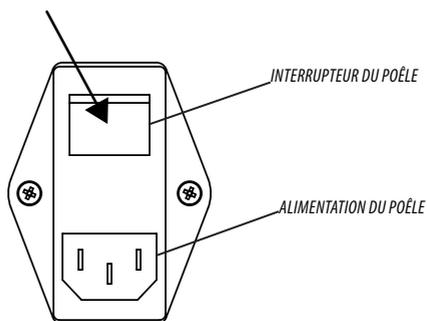
À l'arrière du poêle, un compartiment porte-fusibles se trouve près de la prise de l'alimentation. À l'aide d'un tournevis, ouvrir le couvercle du compartiment porte-fusibles et si besoin est, les faire remplacer (3,15 A retardé) - par un technicien autorisé et qualifié.
