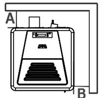
Si le sol est constitué d'un matériau combustible, il est conseillé d'utiliser une protection en matériau incombustible (acier, verre...) qui protège aussi la partie frontale de la chute éventuelle des produits brûlés durant les opérations de nettoyage. L'appareil doit être installé sur un sol ayant une capacité de charge appropriée.
