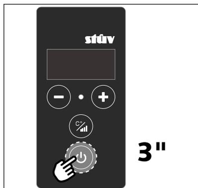
Dans l'éventualité d'un dysfonctionnement ou d'un défaut d'accès à l'application ou à la télécommande, une pression de 3 secondes sur le bouton
