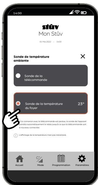
La sélection "**sonde de température ambiante**" permet de sélectionner l'origine de la mesure de la température: soit la sonde intégrée à la télécommande, soit celle intégrée au foyer.
