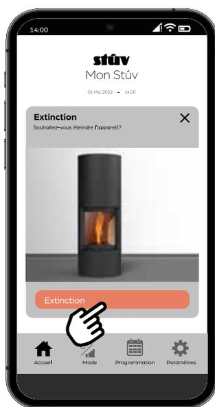
Une fois le cycle d'extinction initié, l'apport en granulés du réservoir est interrompu et la seconde vis de chargement se vide complètement. Le Stûv P20-S continue donc à fonctionner pendant environ 15 minutes à une puissance équivalente à P10.
