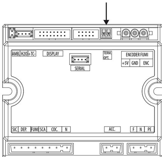
La température du poêle peut être commandée aussi par un thermostat d'ambiance externe. Celui-ci doit être placé dans une position médiane par rapport à la pièce d'installation et il garantit une plus grande correspondance entre la température de chauffage requise à la chaudière et celle qu'elle fournit effectivement.
