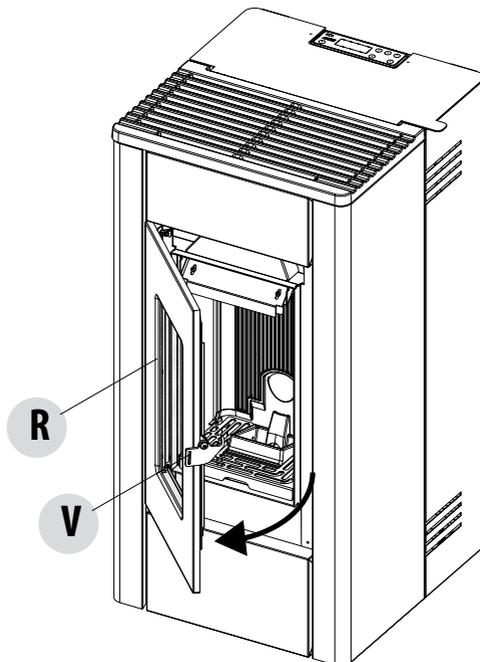
La poignée « V » est située dans la partie supérieure, sous le couvercle du réservoir à granulés, sur le côté droit du poêle (côté poignée).
