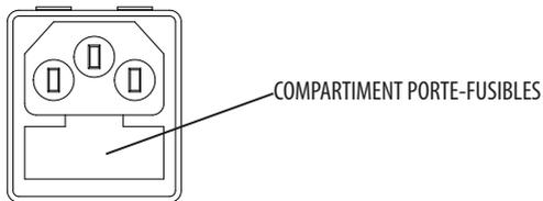
Si au rallumage, en appuyant sur l'interrupteur général placé sur le côté du produit, l'écran du panneau de contrôle ne s'allume pas, cela signifie qu'il pourrait être nécessaire de remplacer le fusible de service.
