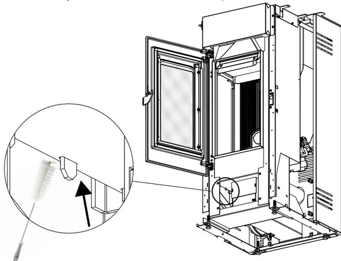
Procéder ensuite en enlevant l'élément en calorite supérieure « H », pour cela ouvrir la porte du foyer, en haut avec les mains lever la plaque en calorite « H » vers le haut, l'incliner vers la droite ou la gauche de façon à la faire sortir des supports et l'enlever.
