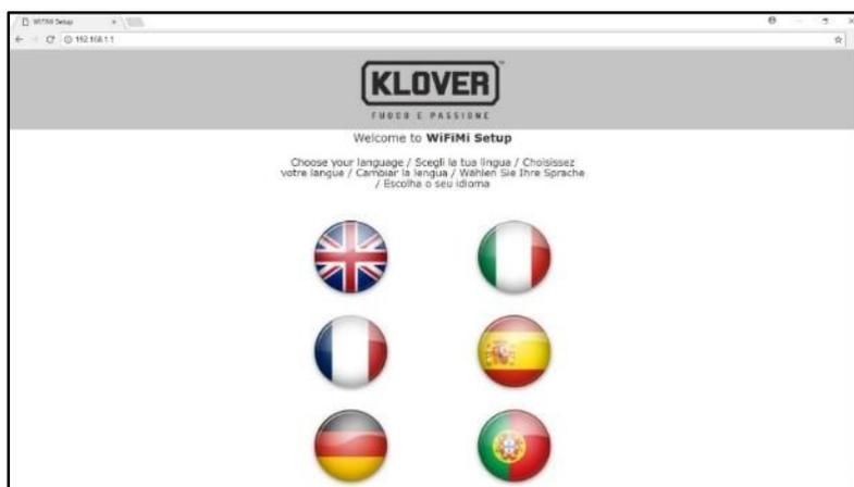
6. Une nouvelle page s'ouvrira (Bienvenue dans WiFiMi Setup) qui indique les données relatives à la configuration précédente. S'il faut reconnecter le module au réseau indiqué, aller dans le « Menu 08 - ETAT WIFI » de la radiocommande, sélectionner l'élément « RESET » et attendre que sur l'élément « ETAT WIFI » soit présente la valeur « 08 » (Module connecté). S'il faut opter pour la connexion à un nouveau réseau, appuyer sur la touche « Rechercher les réseaux WiFi ».
