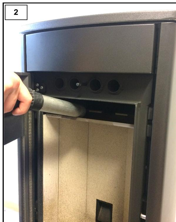
Utiliser le *crochet de nettoyage du racleur avant* spécial pour saisir la tige puis la bouger en avant et en arrière pour nettoyer l'échangeur d'air des résidus de combustion (figure 1). Aspirer ensuite le résidu de cendres qui s'est déposé au-dessus du diffuseur de flamme (figure 2).
