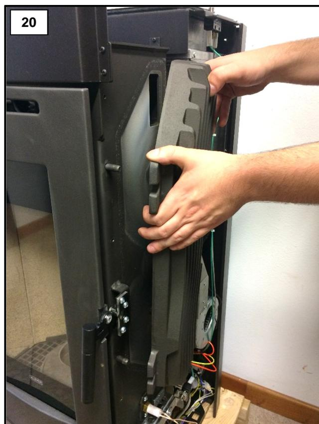
Démonter l'échangeur en fonte (figure 20) en dévissant les 4 écrous indiqués sur la photo (figure 19).
