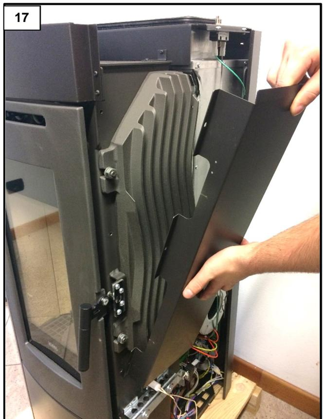
Démonter le couvercle de l'échangeur en fonte (figure 17) en dévissant les cinq vis indiquées sur la photo (figure 16).
