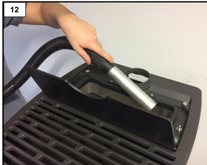
Pour un fonctionnement correct, il est nécessaire d'aspirer le dépôt de sciure présent sur le fond du réservoir (figure 12) au moins tous les 30 jours. **À chaque fin de saison, il faut vider complètement le réservoir à granulés.**
