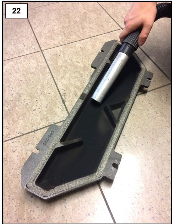
Raclar avec une petite spatule en acier et aspirer les parois latérales du poêle (figure 21) ainsi que les parois intérieures de l'échangeur en fonte (figure 22).
