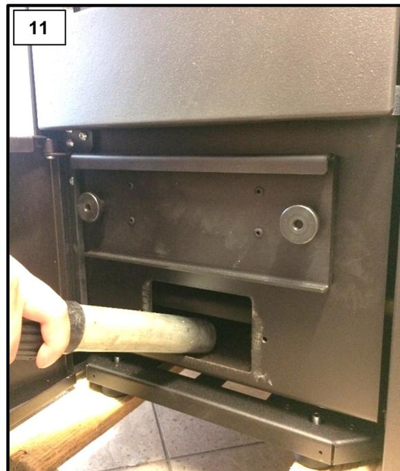
Retirer le clapet d'inspection en dévissant les deux vis (figure 10) et aspirer les résidus présents à l'intérieur du logement inspecté (figure 11).
