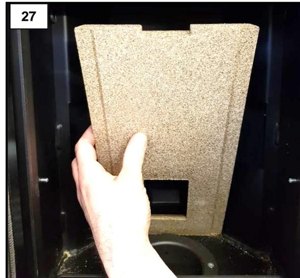
Pour retirer les plaques en vermiculite, il faut d'abord retirer les plaques extérieures puis celle située à l'arrière (figures 26 et 27).
