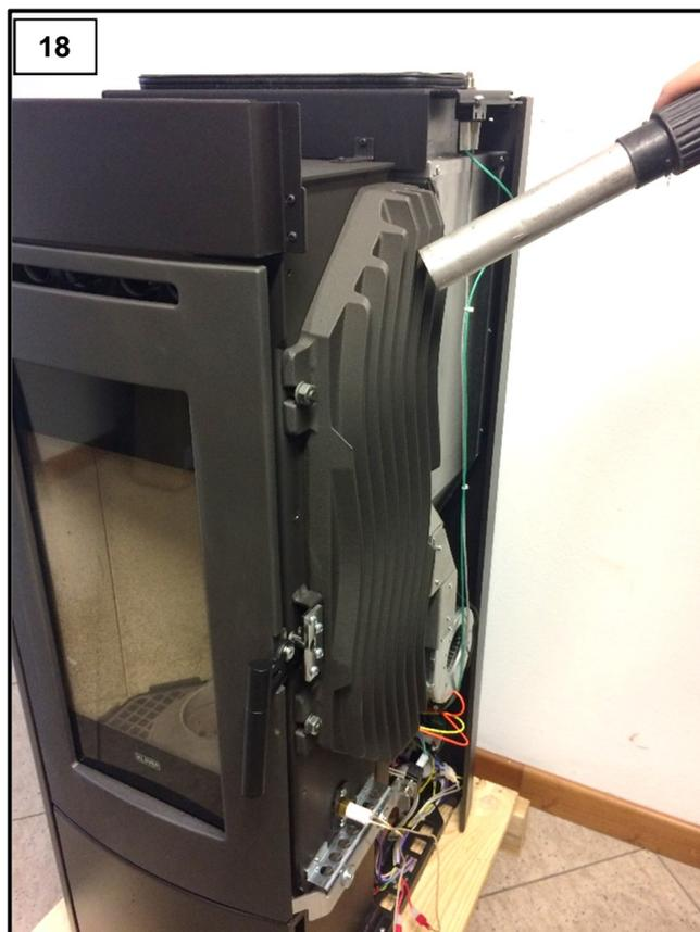
Nettoyer avec un écouvillon ou un aspirateur l'éventuel dépôt de poussière présent sur l'échangeur en fonte (figure 18).
