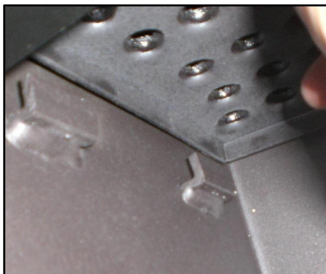
Repositionner le diffuseur de flamme en prenant soin de l'attacher aux deux languettes à l'intérieur de la chambre de combustion.
