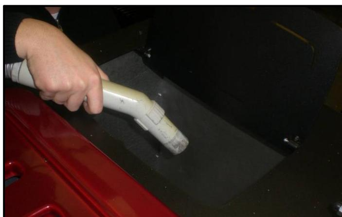
Pour un fonctionnement correct, il faut aspirer le dépôt de sciure dans le fond du réservoir de pellet au moins tous les 15 jours. À la fin de chaque saison, vider entièrement le réservoir à pellets.
