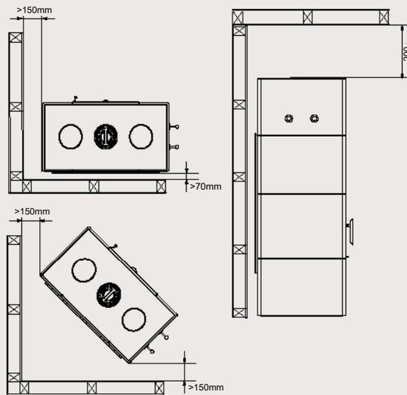
En cas de pose libre, sans cloison pare-feu à l'arrière, la distance minimale entre l'arrière de la cheminée et des matériaux inflammables doit être de 800 mm.
