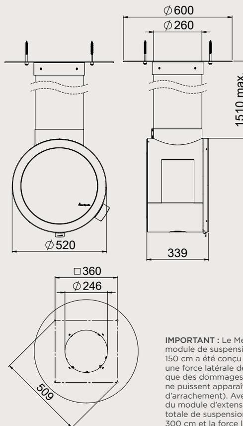
**IMPORTANT :** Le Me Ceiling avec module de suspension standard de 150 cm a été conçu pour résister à une force latérale de 100 kg avant que des dommages esthétiques ne puissent apparaître (risque d'arrachement). Avec l'utilisation du module d'extension, la longueur totale de suspension peut atteindre 300 cm et la force latérale diminue d'environ 50 kg avant l'apparition des mêmes dommages. Le poêle deviendra moins stable latéralement lorsqu'il est installé avec une longueur standard de 150 cm.
