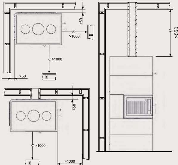
En cas de pose libre, sans cloison pare-feu à l'arrière, la distance minimale entre l'arrière de la cheminée et des matériaux inflammables doit être de 800 mm.
