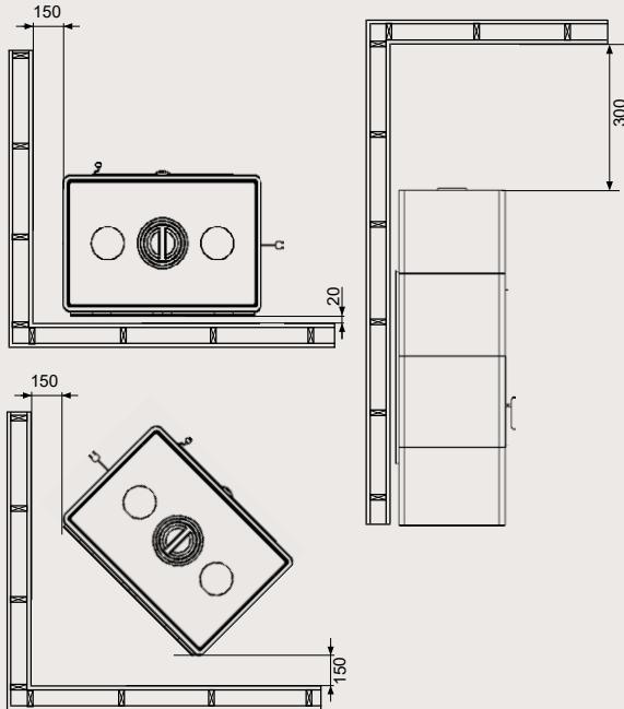
En cas de pose libre, sans cloison pare-feu à l'arrière, la distance minimale entre l'arrière de la cheminée et des matériaux inflammables doit être de 800 mm.
