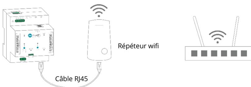
**Figure 4 : Schéma de connexion internet via répéteur wifi**
