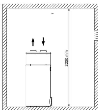
**Aspiration et refoulement dans un local :** aroSTOR collecte les calories du local et rejette un air plus froid et plus sec. Cette solution est adaptée à une chaufferie d'une taille minimale de 20 m<sup>3</sup> et disposant d'une ventilation suffisante.
