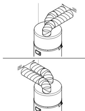
**Aspiration et refoulement à l'extérieur :** aroSTOR capte l'énergie de l'extérieur, puis le rejette dehors. Ainsi, il ne refroidit ni ne perturbe la ventilation du local. Cette solution est idéale pour minimiser le niveau sonore.
