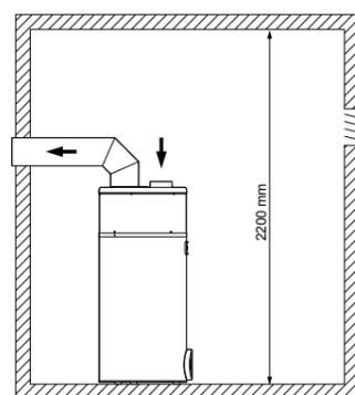
**Aspiration dans un local et refoulement à l'extérieur :** aroSTOR collecte les calories du local et rejette l'air à l'extérieur. Il ventile ainsi le local, qui doit cependant faire au moins 20 m<sup>3</sup> et disposer d'une amenée d'air suffisante.
