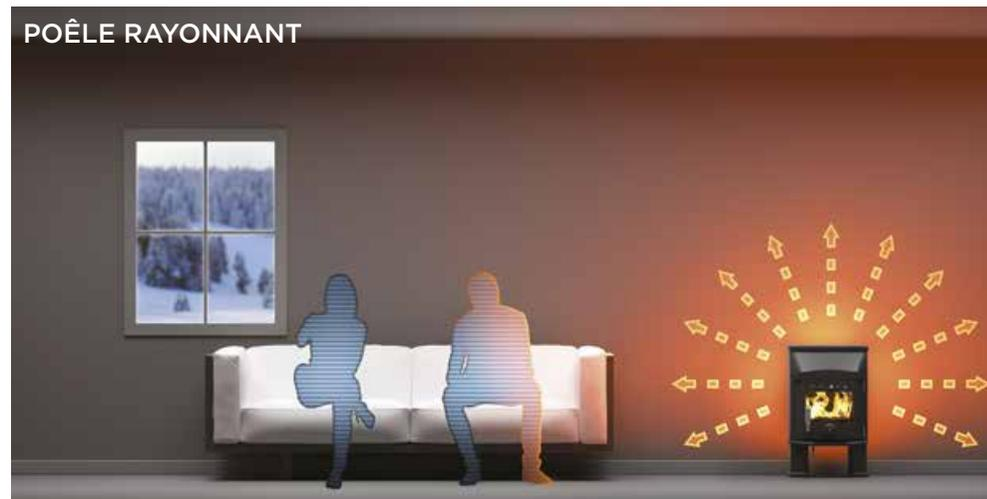
Les illustrations montrent la différence de répartition de la chaleur entre une installation à convection (cheminée à insert ou poêle à double paroi) et un poêle rayonnant (poêle en fonte classique, sans plaques de convection).
