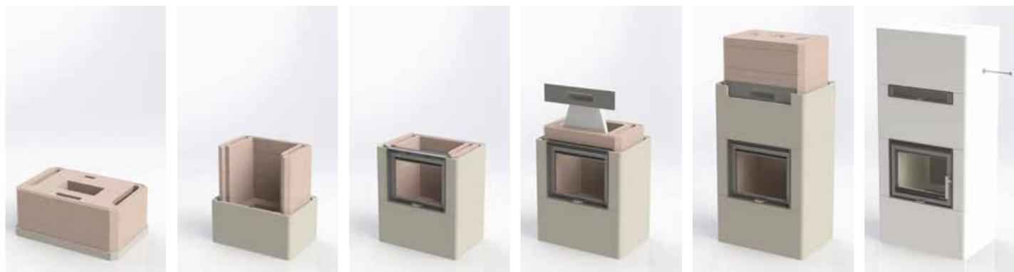
Salzburg possède un cœur à accumulation de chaleur en PowerStone™, facile à monter. La chambre de combustion est garnie de Thermotte™, un béton spécial conçu pour résister à une chaleur élevée. (Illustration Salzburg L)
