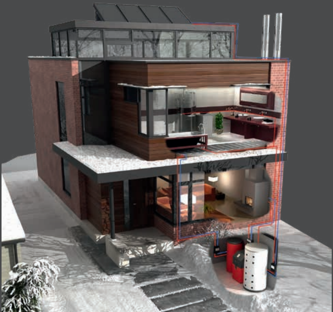
Coupe d'un foyer à convection d'eau intégré dans un circuit de chauffage
